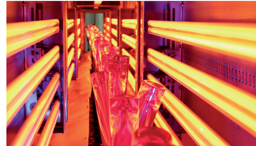
Trocknen von Beschichtungen auf Glasflaschen
